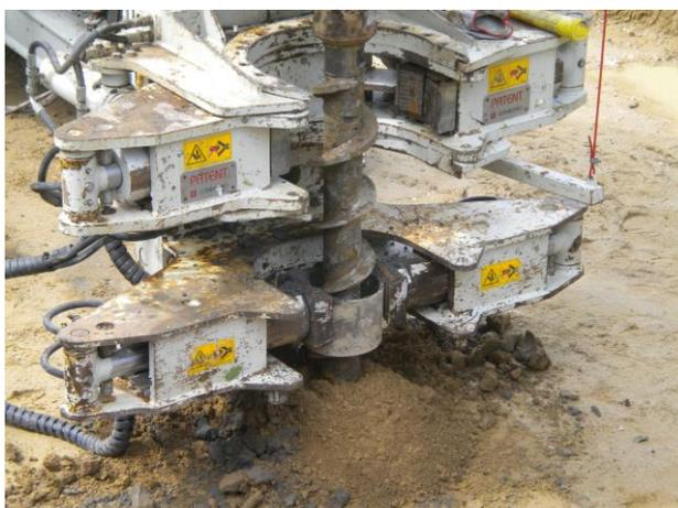
Fig.2.2 – perforazione a rotazione
