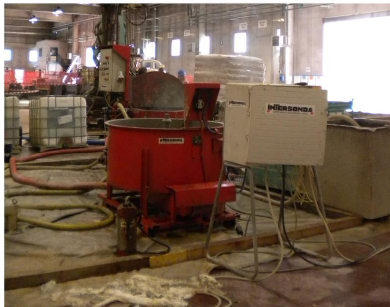
Fig.2.4 – impianto di miscelazione , pompa di iniezione e tubazione ad a.p. collegato alla testa della perforatrice
