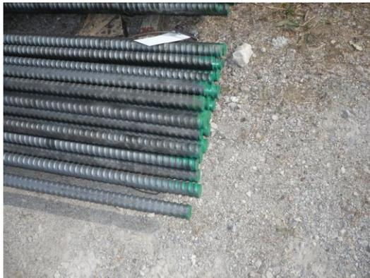
Fig.2.4 – barre a filettatura continua di 6mt
