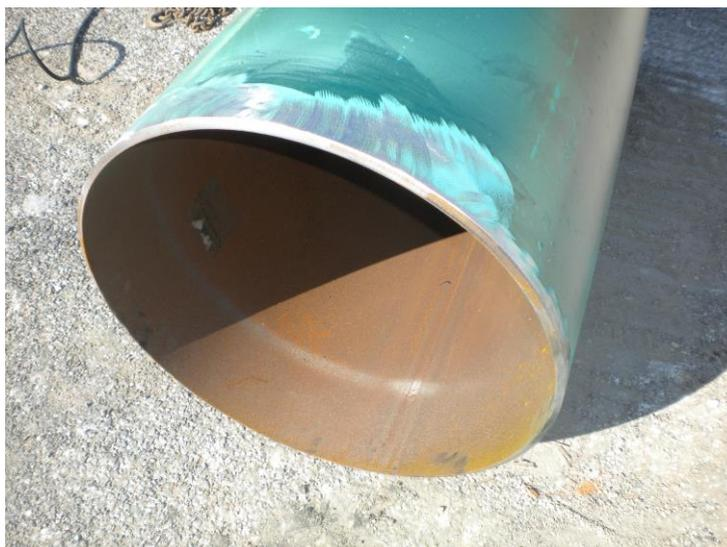
Fig.1.2b – parte terminale del tubo/controtubo lavorata per l'assemblaggio mediante saldatura
